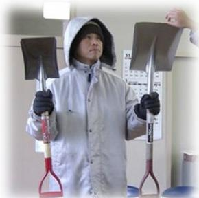
片付けられるうちにはいいのですが、だんだん氷が固くなるとヘリが曲がって使い物にならなくなります。そんな時は鉄製の角スコップが活躍します。ただ鉄角スコップはアルミ製より重いのが短所ですね。(ちなみに、ボランティアセンターで貸し出し中の鉄角スコップは、佐藤専門員が持っている2本のサイズのちょうど真ん中サイズでお手頃です♪)
